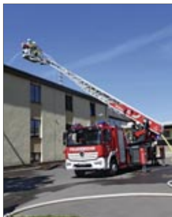
Löscheinsatz mit der Drehleiter.
